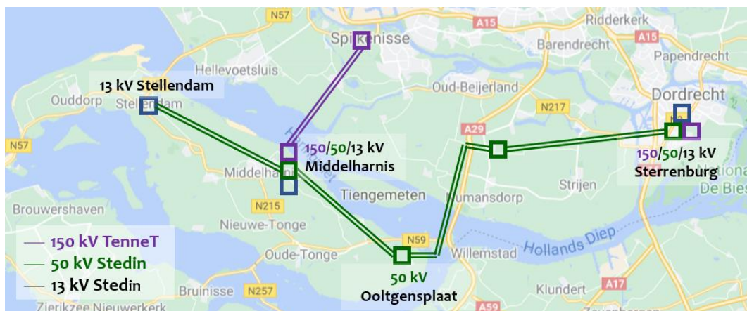
Figuur 3. Het 50 kV elektriciteitsnet en de 50/13 kV transformatoren op Goeree-Overflakkee.
